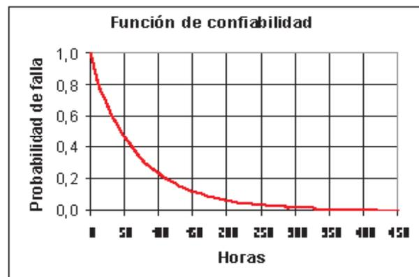
La función de fallas acumuladas, indica la probabilidad de que un equipo no llegue con vida a un determinado instante t. Analizando la gráfica de confiabilidad (complemento de la función de fallas acumuladas), se observa que la confiabilidad baja o decrece rápidamente, dando como resultado que al pasar las 50 horas de operación, ya existe el 50% de probabilidades de que
