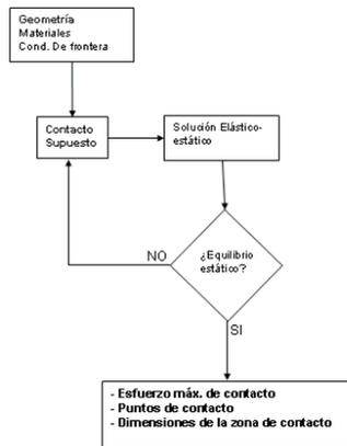
El procedimiento para determinar la conicidad equivalente es muy similar al realizado para determinar los esfuerzos, solo que se siguen las suposiciones indicadas en la norma UIC-519, el diagrama de este procedimiento es el mostrado en la Figura 6, las suposiciones hacen que dentro de la parte de pre-procesamiento es ingresar un módulo de elasticidad bastante alto para suponer la rigidez del sistema.
