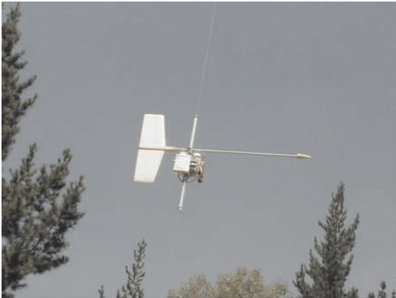
Figura 2: Veleta, anemómetro y adquisidor de datos analógicos con sistema mecánico de alineación
