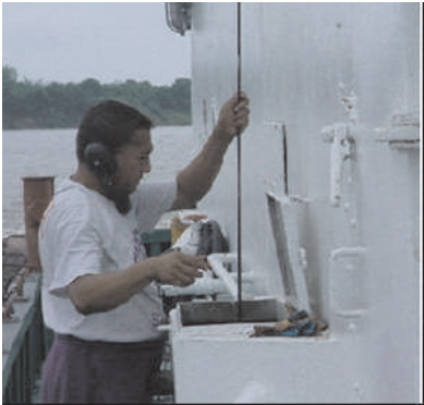
Figura 2: Método de medición anterior, de la cantidad de combustible en los tanques
