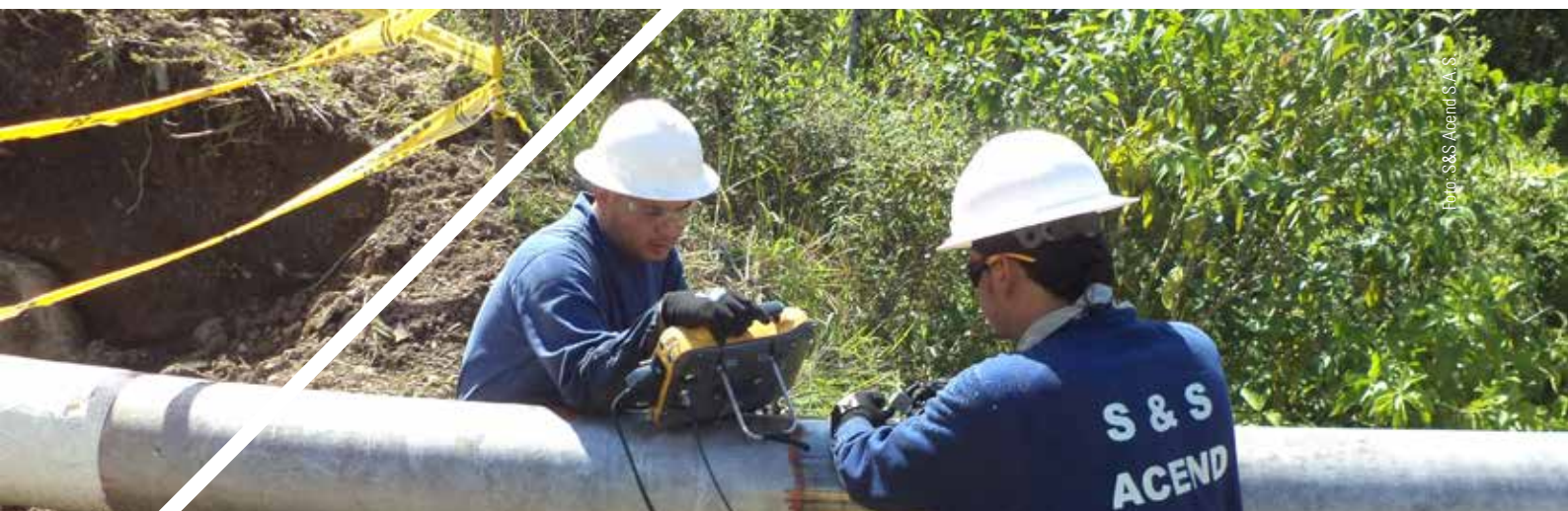
S&S Acend S.A.S. es una de las 236 compañías que ha sido asesorada por estudiantes de la especialización en Gerencia del Desarrollo Humano de EAFIT. En la imagen, en el Poliducto Medellín-Cartago, ingenieros de la empresa hacen un examen por ultrasonido a una tubería.
