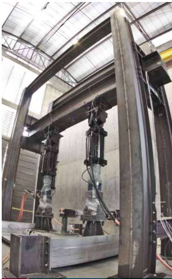
El sistema incluye un muro de reacción lleno de agujeros de los que se sujetan los actuadores que aplican las cargas a los elementos analizados en el Laboratorio.
