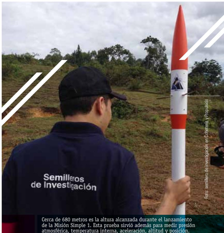
Cerca de 680 metros es la altura alcanzada durante el lanzamiento de la Misión Simple 1. Esta prueba sirvió además para medir presión atmosférica, temperatura interna, aceleración, altitud y posición.
