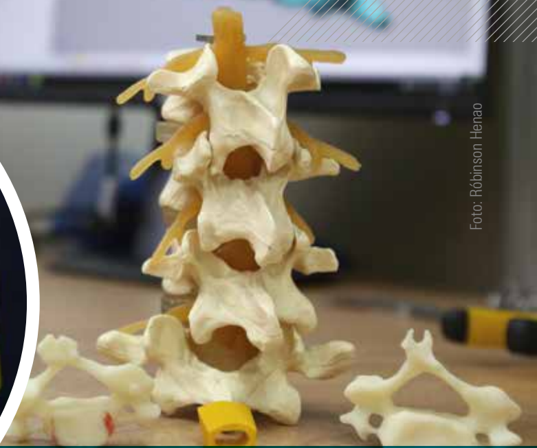
Impresión 3D del Implante para remplazo vertebral.
