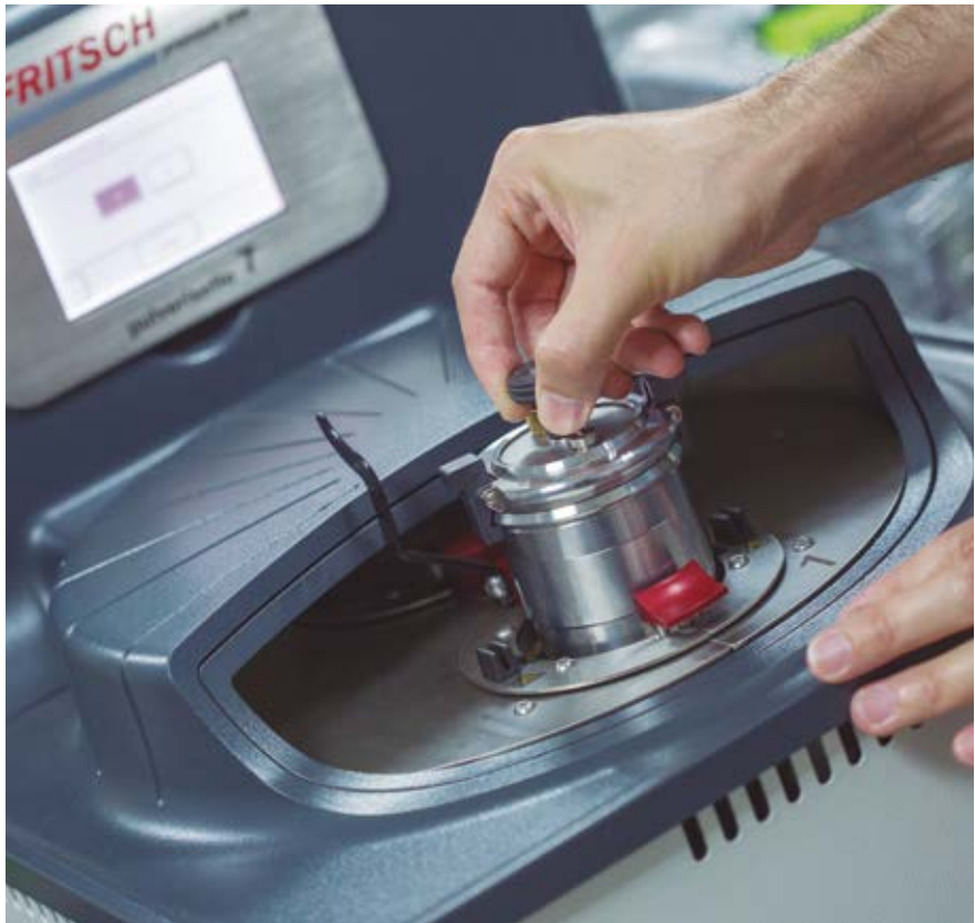
En un reactor se hizo la síntesis de las nanopartículas magnéticas. Se empleó la técnica denominada molienda mecánica de alta energía. Foto Robinson Henao.
