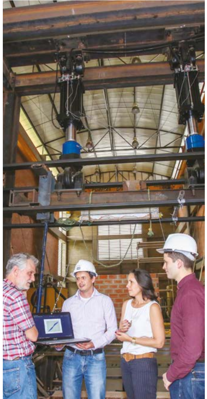
La Mesa Vibratoria es una plataforma que permite tomar los "signos vitales" de una estructura sometida a las mismas presiones de un sismo, para estudiar su comportamiento. Foto Robinson Henao.
