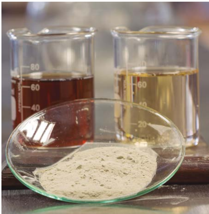
La arcilla desarrollada captura las sustancias que causan el mal olor y la oxidación en el aceite. Foto Robinson Henao.
