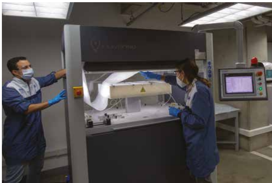
La membrana creada es capaz de retener aerosoles cuyo tamaño es nanométrico, como el que puede transportar el COVID-19. Un primer uso fue en la realización de mascarillas que han probado su alta eficiencia. Foto Róbinson Henao.
